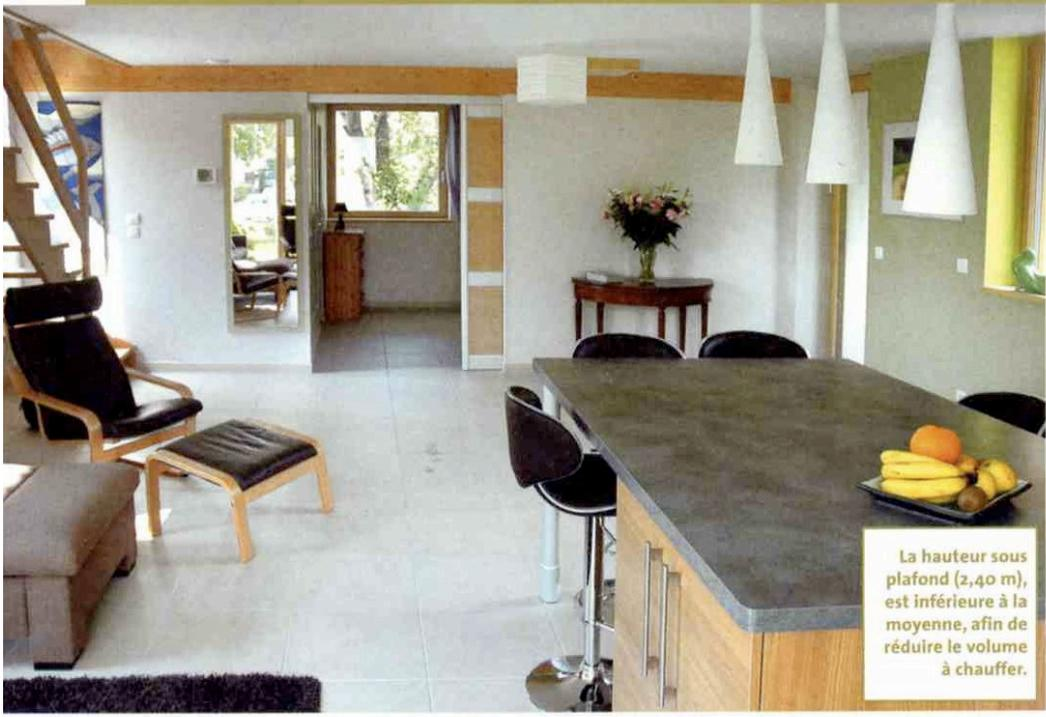
La hauteur sous plafond (2,40 m), est inférieure à la moyenne, afin de réduire le volume à chauffer.
